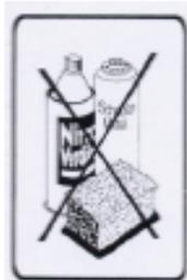
Außen-, Innenseite und der Falzbereich sollten regelmäßig gereinigt werden. Leichte Verschmutzungen der Rahmenoberflächen sind mit handwarmem Wasser unter Beigabe von schonenden Haushalts-Reinigungsmitteln zu säubern. Wir empfehlen zur Reinigung bei starker Verschmutzung die unten genannten Spezialreiniger der Firma Schüco. Erhältlich sind diese Pflegemittel bei der Fa. Wiegmann GmbH oder im entsprechenden Fachhandel.
